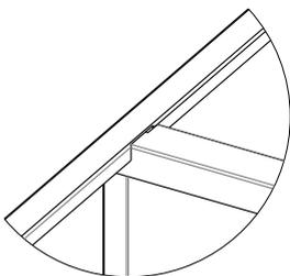
6° Com a prateleira (PRA) inclinada encaixe-a nas laterais, após encaixada parafuse-a nas costas (FU).
