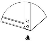
5° Una as peças: lateral, costas, e base, fixe com parafuso M4x6mm e porca M4.
